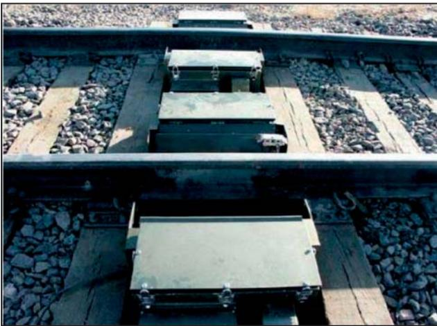
Die stationär im Gleis eingebaute Überrollanlage dient zur automatischen Messung verschiedener Parameter an montierten Radsätzen während des Überfahrens der Züge. Die Anlage wird vorrangig auf Durchfahrtstrecken oder im Einfahrbereich von Werkstätten/Depots installiert. Der Zustand der Radsätze wird kontinuierlich überwacht, und vorbeugende Maßnahmen für notwendige Reparaturen werden abgeleitet.
