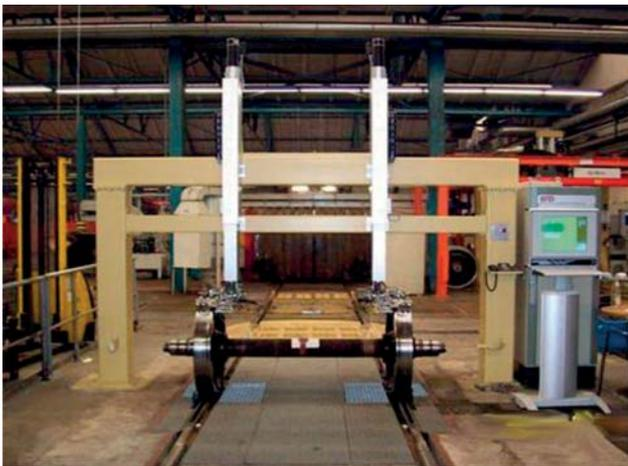
Die international im Einsatz erprobte Anlage ermöglicht, Radscheiben vollautomatisch auf Risse in der Struktur auf andere Belastungsschäden zu prüfen.
