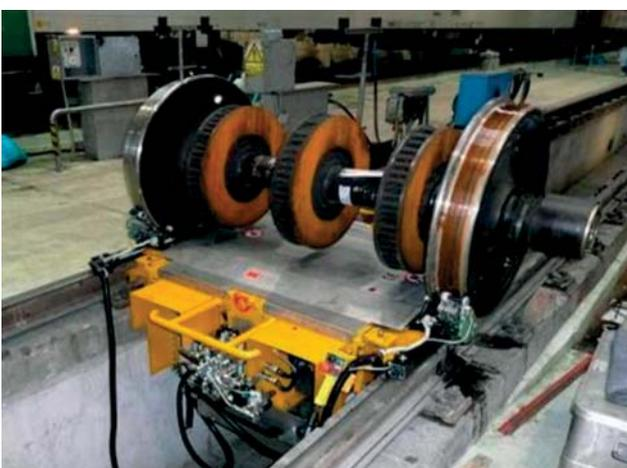
Die Anlage ermöglicht eine Prüfung verschiedenster Radsatztypen im Depot. Die gesamte Datenaufnahme und Aufarbeitung findet auf dem Gerät statt. Die Online- und Ergebnisdarstellung erfolgt auf dem zugehörigen Rechner außerhalb der Anlage. Die Datenübertragung erfolgt über W-LAN, womit eine aufwändige Kabelverbindung entfällt.
