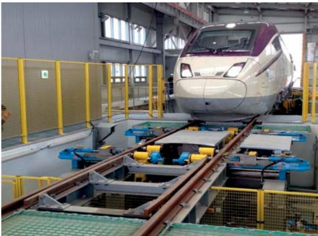
Die stationäre, im Gleisbereich installierte Ultraschall-Unterflurprüfanlage ermöglicht, alle Radsätze im eingebauten Zustand am durchgetakteten Zug automatisch zu prüfen. Resultierend aus Prüfung von Teilbereichen, wie äußere Lauffläche, Radkranz, Spurkranz auf Längs-, Quer-, Volumen-, und Oberflächenfehler ergeben sich über die Parameterauswertung die notwendigen Instandhaltungsmaßnahmen.
