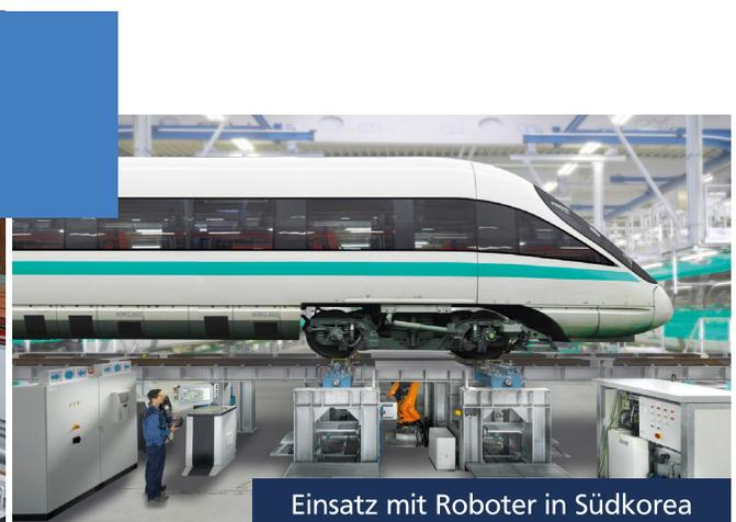
Die prüftechnische Ausstattung der Anlagen ist flexibel auf die jeweiligen Kundenbedürfnisse abstimmbare. Das Auffinden von Fehlern mit Hilfe von Ultraschall auf der inneren Stirnfläche oder Lauffläche ergänzt durch Wirbelstromprüfung ist ebenso möglich wie eine Kombination aus konventioneller und „Phased Array“ Prüftechnik.
