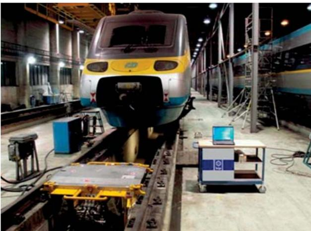
Die im Gleisbereich mobile Ultraschallprüfanlage ermöglicht, alle Radsätze im eingebautem Zustand am stehenden Zug automatisch zu prüfen. Entsprechend den allgemeinen prüftechnischen Anforderungen werden die Ergebnisse angezeigt bzw. gespeichert.
